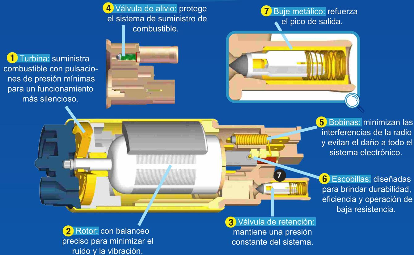
Destacamos el buje metálico (ítem 7), introducido en el pico de salida de la bomba.
